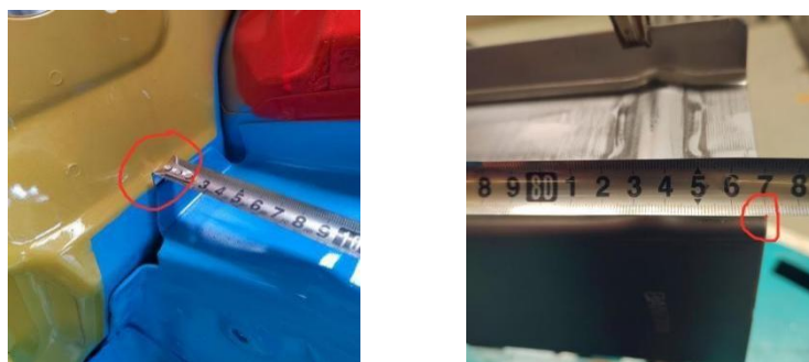
图 20：（纵梁上侧长度：870mm）
