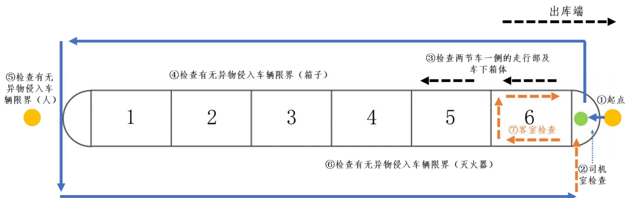
车辆外观、司机室、走行部及车下结构 巡视检查路线示意图
