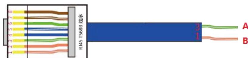
图 7 RS485 接线图
