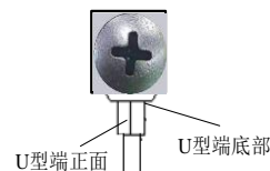
图 5 U型冷压头与端子排连接示意图
