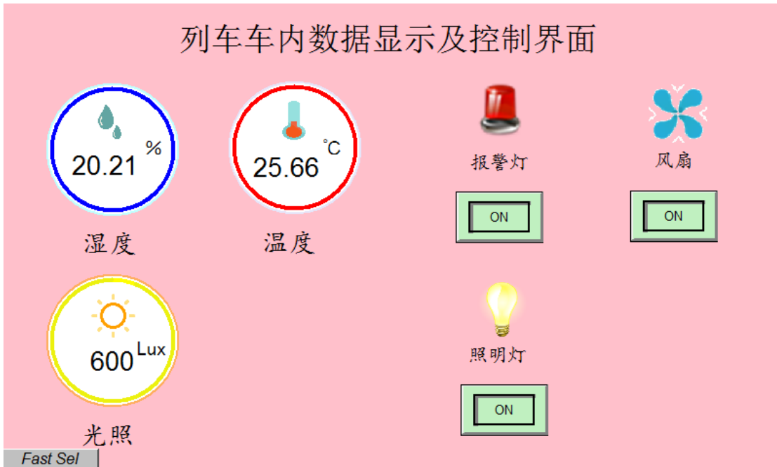
图 4.3 数据显示及控制界面示例（使能有效）
