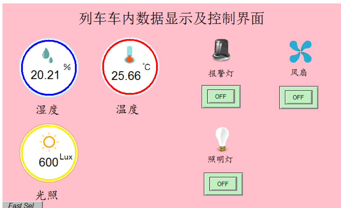
图 4.4 数据显示及控制界面示例（使能无效）
