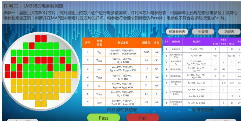
附图 5 LM358 电参数测定界面示意图
