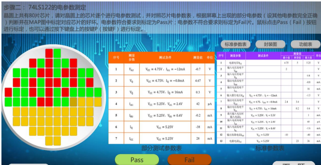
附图 4 74LS122 电参数测定界面示意图
