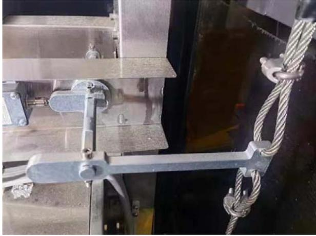
图 2 钢丝绳连接示意图
