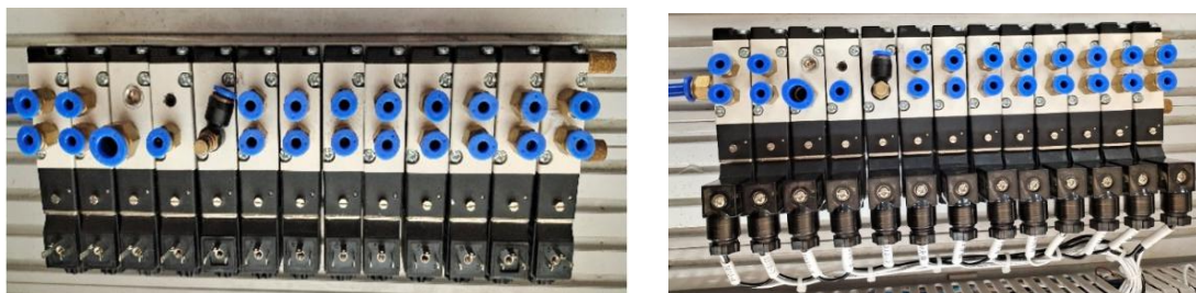
图 A-9 电磁阀安装前和安装后示意图
