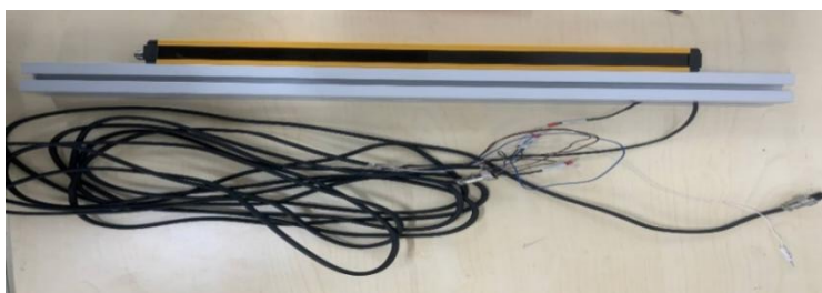
图 A-8 光栅装配器件和电气接线
