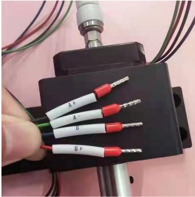
θ 轴如上图所示，共有四根线需要接入控制面板。
