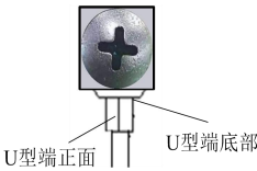
图 5 U 型冷压头与端子排连接示意图
