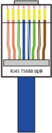
图 6 RJ45 T568B 线序
