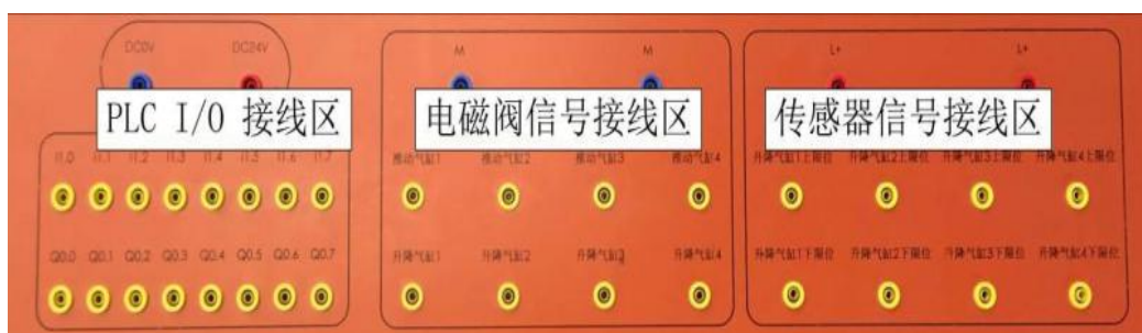
图 A-23 PLC 的 IO 信号接线区域
