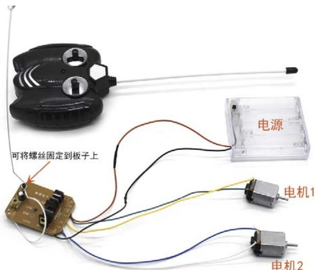
图 9 遥控连接示意图
