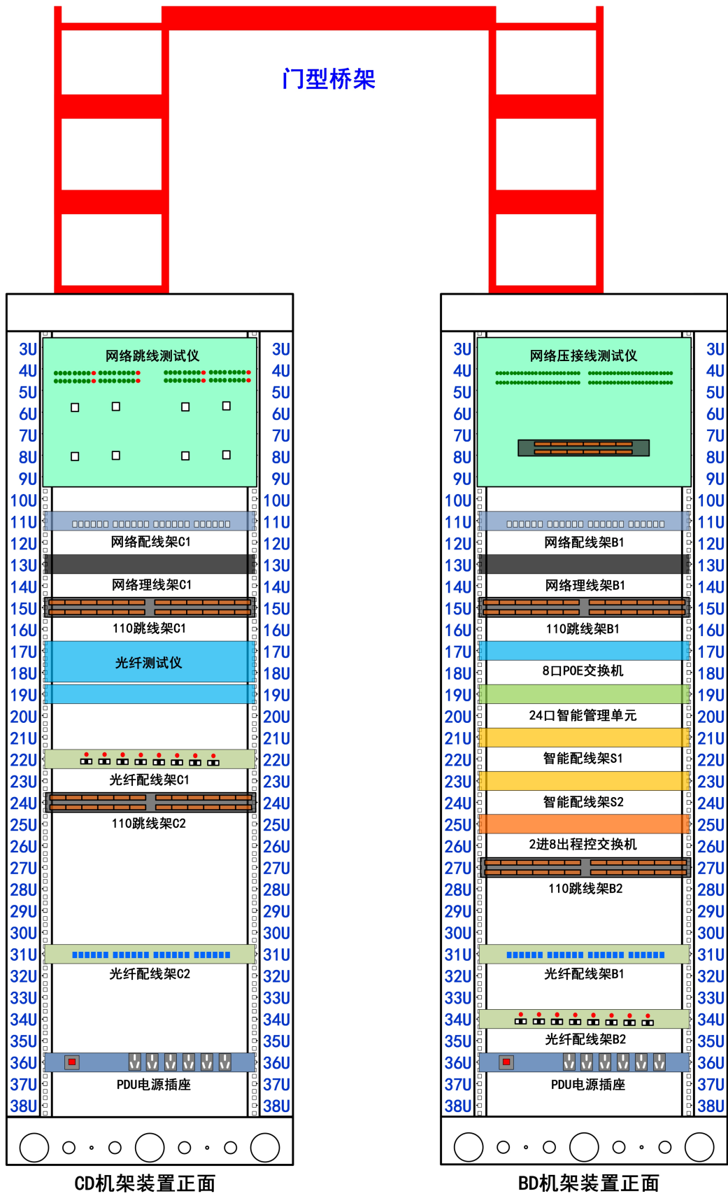
图7 模拟 CD、BD 机架装置设备安装位置图
