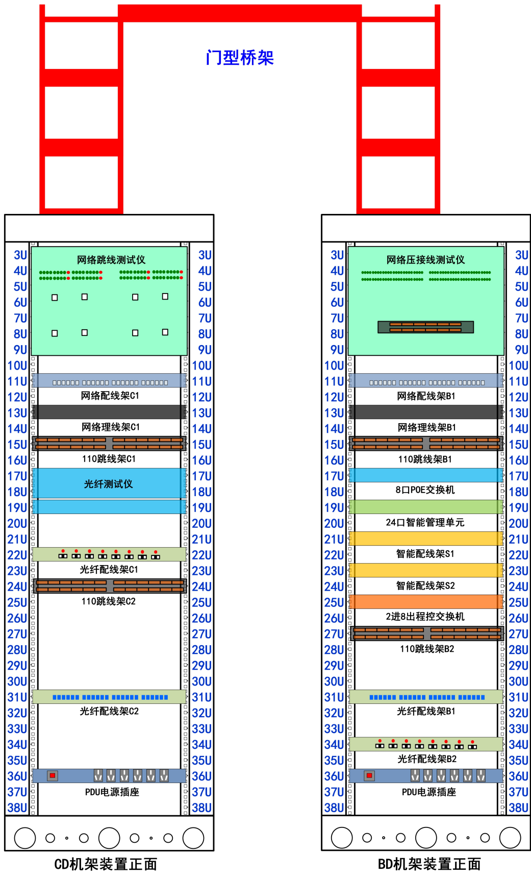
图7 模拟CD、BD机架装置设备安装位置图
