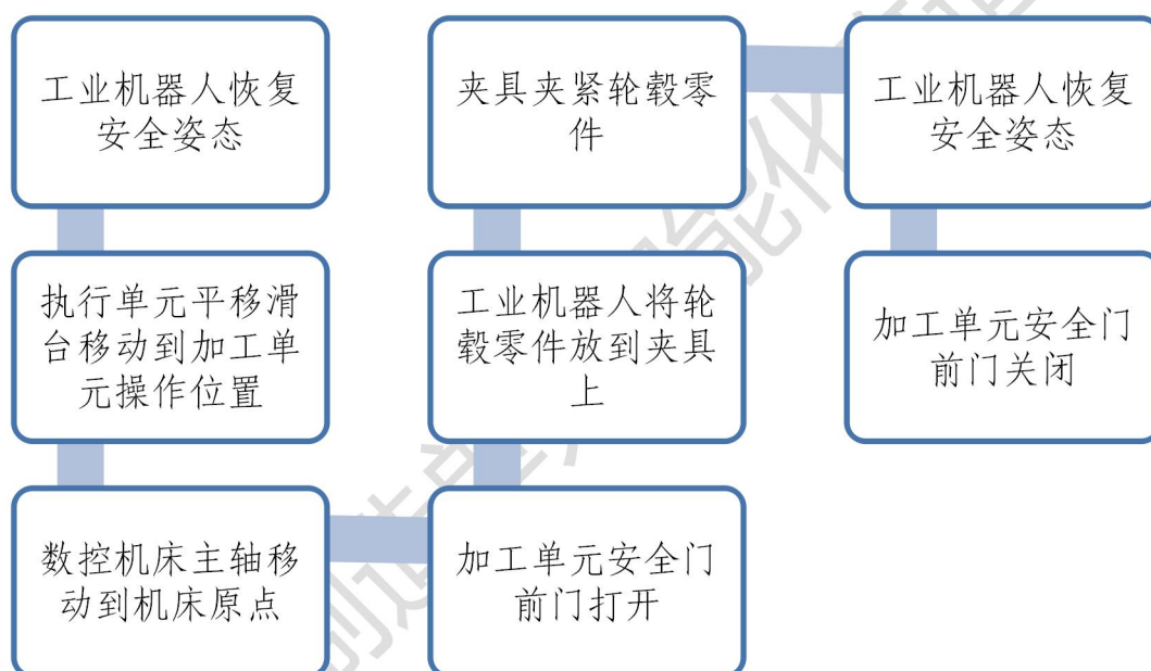
图 1-3 数控加工正面上料工序流程
