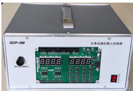
图 2 水果采摘机器人控制器机箱图
